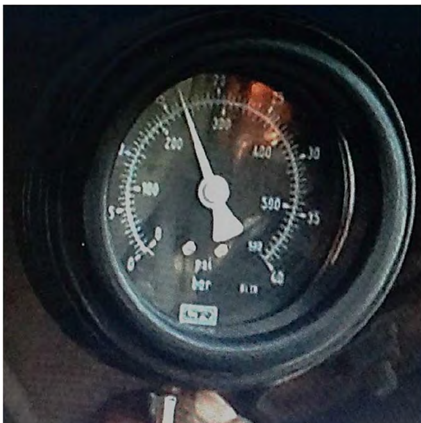
Imagem 3: Resultado da medição da compressão antes do tratamento
